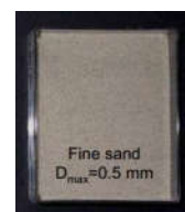
Hình 3. Cát quartz dùng để chế tạo bê tông UHPC
