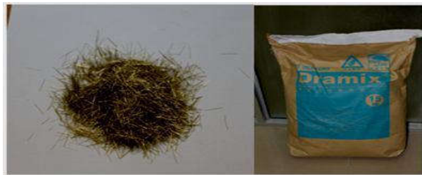
Hình 4. Sợi thép dùng để chế tạo bê tông UHPC
